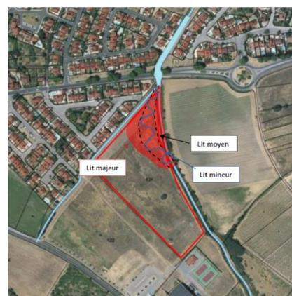
Objectif : le projet est double, réduire les apports de matériaux fins dans l'Agouille de la mar mais également de limiter l'ensablement du pont à l'aval immédiat du chantier, et de réduire les risques d'inondation du Dilouby dans sa traversée urbaine.
